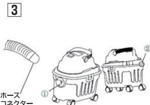
ホースコネクターを①に差し込むと、吸引が出来ます。ホースコネクターを②に差し込むと、ブロー(吹き出し)が出来ます。
