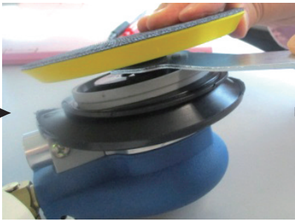
スパナを差し込みパッドを押しながら 中心部の取付ねじを反時計回りに回す
