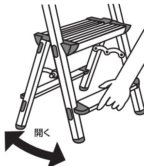
②次に、開き止め金具を上から押させて、確実にロックしてください。
