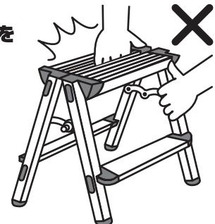
開き止め金具(開き止め装置)のロックが不十分な状態で使用すると、脚が開閉し、転落や転倒の恐れがあります。
