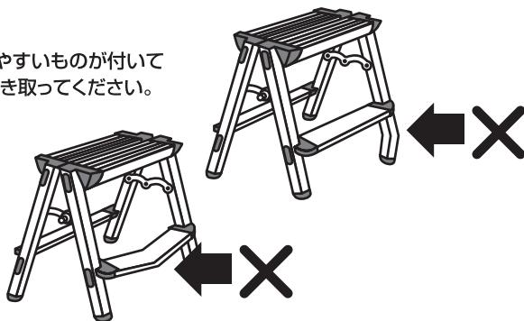
■各部の接合箇所に割れや腐食、また、取付け部品の破損・脱落・変形・摩耗・腐食がある場合は、絶対に使用せず廃棄してください。
