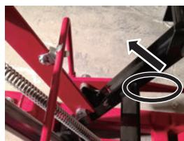
④両手で車輪をしっかりと押さえながらフットペダルをゆっくり踏み、車輪を必要な高さまで持上げます(3段階ロック位置のうち必要な高さまで)。
