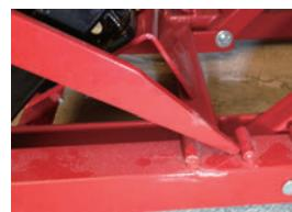
②ロックが解除されたら、ロックプレートを上げてフレームに付いているクリップに挟込みます。
