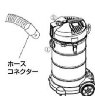
ホースコネクターを①に差し込むと、吸引が出来ます。ホースコネクターを②に差し込むと、ブロー(吹き出しが)出来ます。
