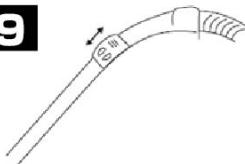
吸込量調整部を上下に動かして、風量を調節してください。
