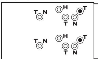
図1および図2はオーディオの正面から見て左側側面の穴位置です。また、右側側面も対称に穴があり「T」の印は、トヨタ車のネジ穴を表しています。
