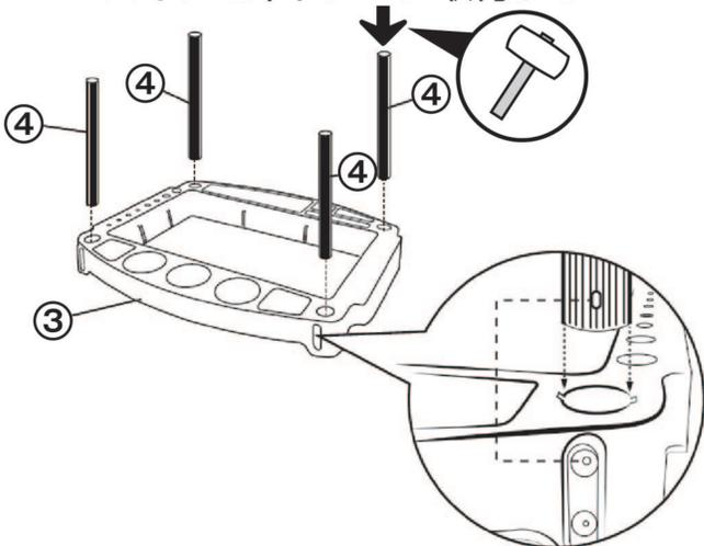
**2** 中トレーとパイプを取付けてから横からネジで固定する。
