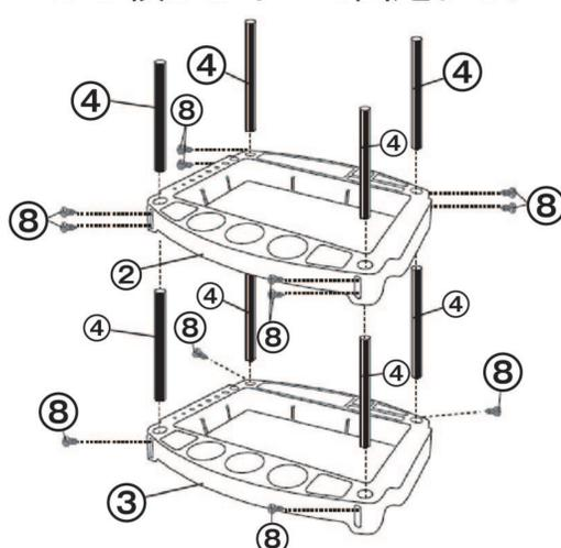
**3** 上トレーとパイプを取付け、横からネジで固定する。キャップを上トレーの四箇所にはめる。
