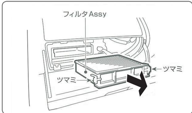
フィルタ Assy 左右のツマミを持ち、フィルタ Assy 全体を手前に引き取り外します。
