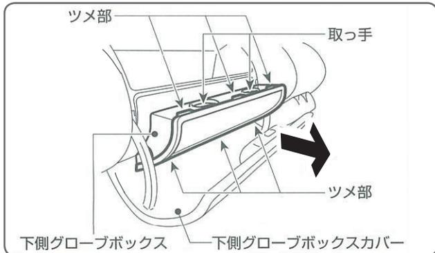
下側グローブボックスカバーを開いて、下側グローブボックス上部の取っ手に指を引っ掛け、手前に引いてツメ部6ヶ所の勘合を外して取り外します。
