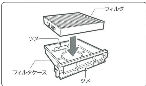
フィルタケースから古いフィルタを外し、新しいフィルタを矢印UPを上に向けて取り付けます。その際フィルタ端部の山をフィルタケースのツメ2ヶ所に差し込みます。
