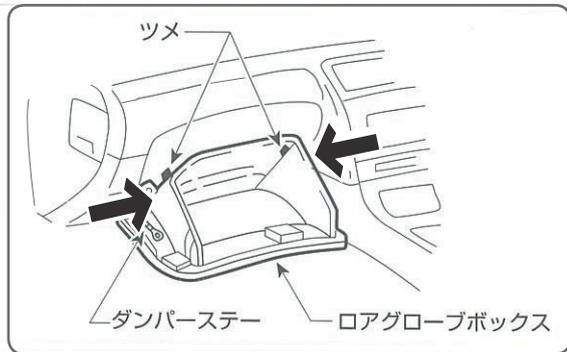
ロアグローブボックスを開け、内側に押しながら上部ツメを左側から片側ずつ外し、ロアグローブボックスを取り外します。(ダンパーステー装着車はダンパーステーを取り外してから外す)。
