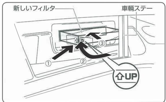
①新しいフィルタを矢印UPの向きを上に向けて斜めにセットします②車輛ステーをさけながら矢印②の方向に回転させます③フィルタを真っ直ぐに取り付けます。
