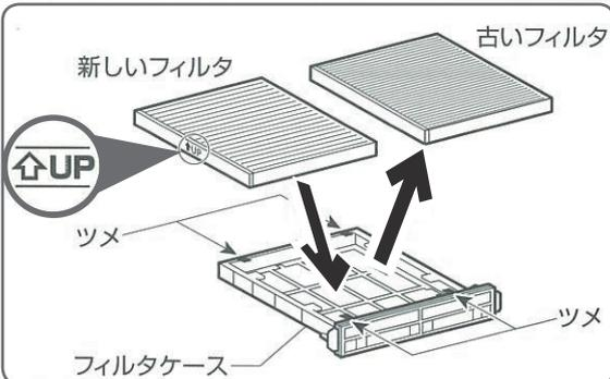
古いフィルタを取り外し、新しいフィルタを矢印 UP の向きを上に向けて取り付けます。
