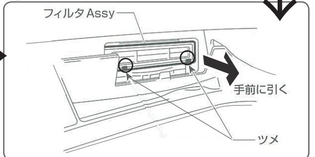
ツメ (2ヶ所) を押してロックを外し、フィルタ Assy を引き抜きます。
