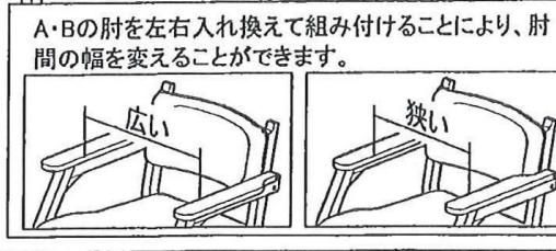
A・Bの肘を左右入れ換えて組み付けることにより、肘間の幅を変えることができます。
