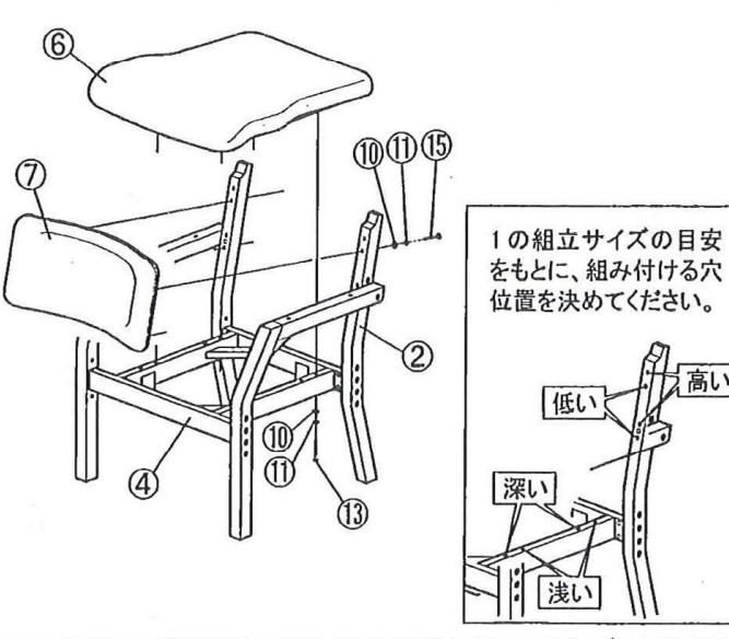
6 ③肘の後側を、②後脚に⑧スペーサーを挟んで⑭ボルト(3)・⑩座金・⑪スプリングワッシャーで軽く組み付けてください。次に、①前脚の下から⑬ボルト(2)・⑩座金・⑪スプリングワッシャーで軽く組み付けてください。
