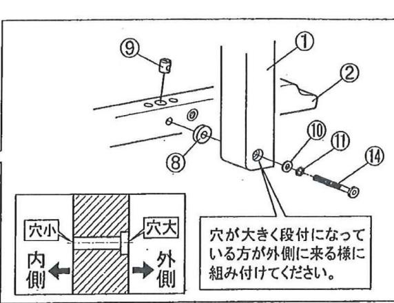
穴が大きく段付になっている方が外側に来る様に組み付けてください。
