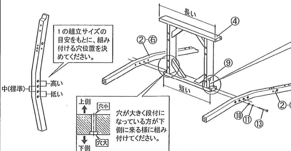
⑨埋め込みナットのネジ穴が、ボルトの方に向く様にドライバーで向きを合わせて貰って、ボルトで組み付けて下さい。
