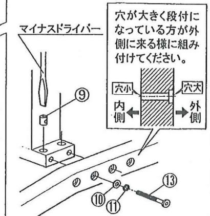
4 3と同様にして、①前脚を、④座貫フレームに⑬ボルト(1)・⑩座金・⑪スプリングワッシャーと⑨埋め込みナットで軽く組み付けてください。①前脚の後側は、②後脚に⑧スペーサーを挟んで⑭ボルト(3)・⑩座金・⑪スプリングワッシャーと⑨埋め込みナットで軽く組み付けてください。
