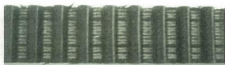
ベルト歯底摩耗（心線露出）
