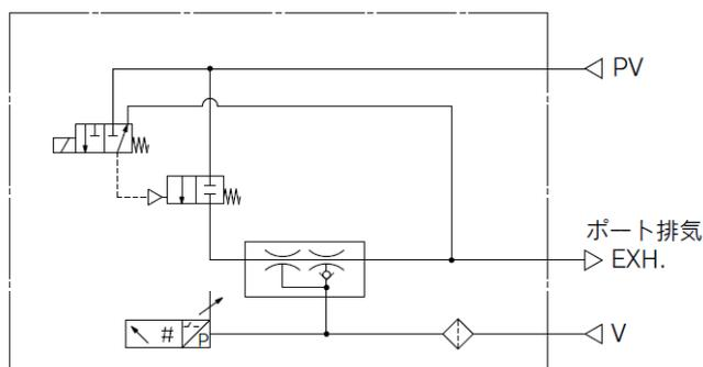
上記回路図は供給弁:N.C. 破壊弁:なし
