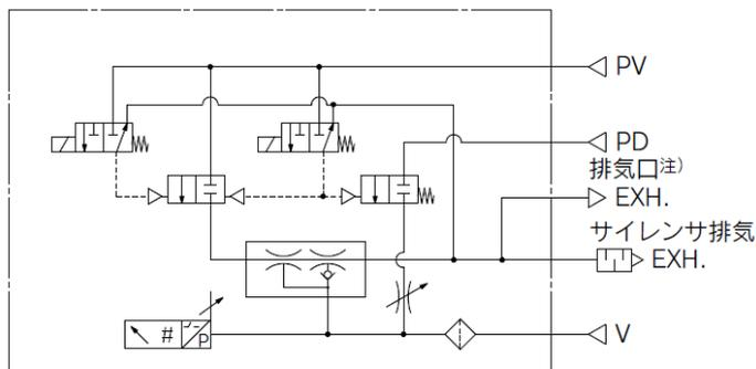
上記回路図は供給弁:自己保持. 破壊弁:N.C.
