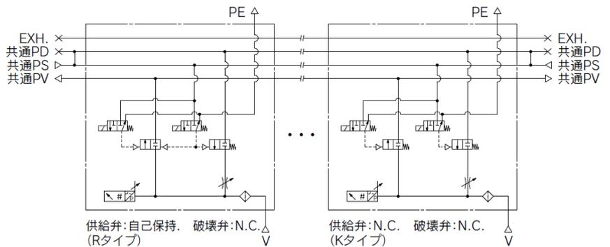
供給弁：自己保持、破壊弁：N.C. (Rタイプ)
