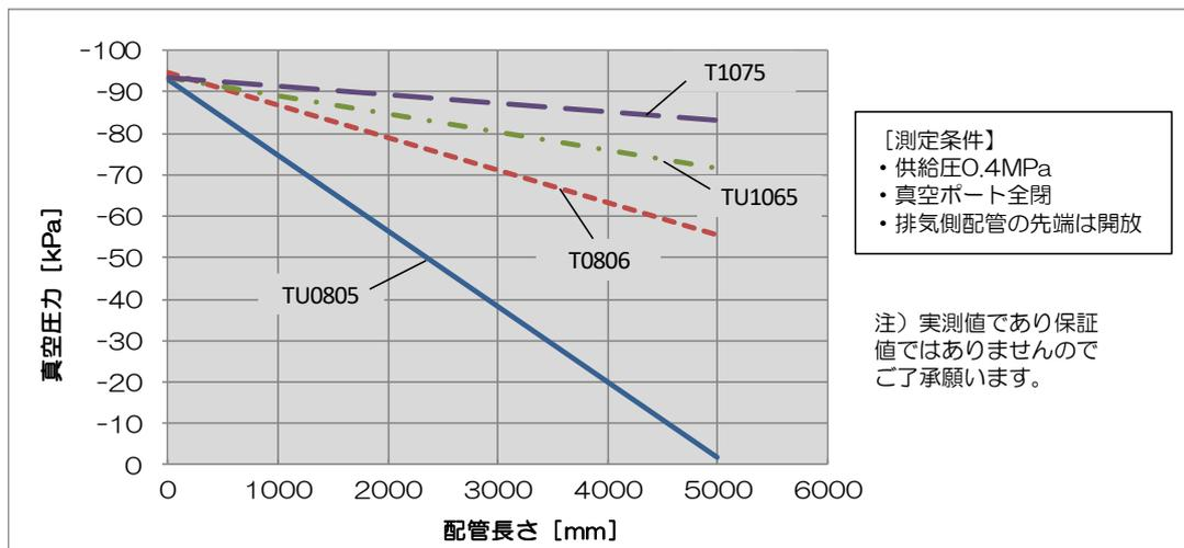
図 A. 配管接続時の真空圧力 (ZK2口15)
