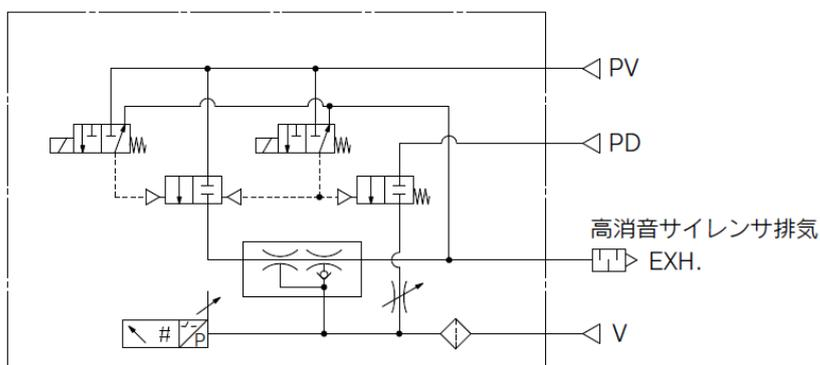
供給弁:自己保持, 破壊弁:N.C. (Rタイプ)
