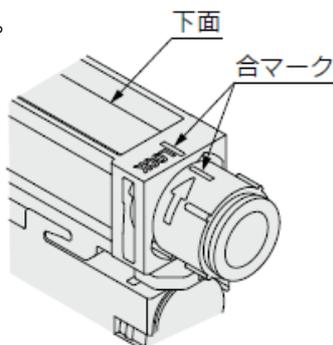
真空ポートアダプタが取外しにくい場合、Vポート内部の六角穴を利用し、六角レンチで作業できます。ポート径と六角対辺は下記の通りです。
