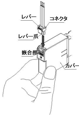
注) コネクタやカバーが破損しますので、リード線を過度に引張らないでください。
