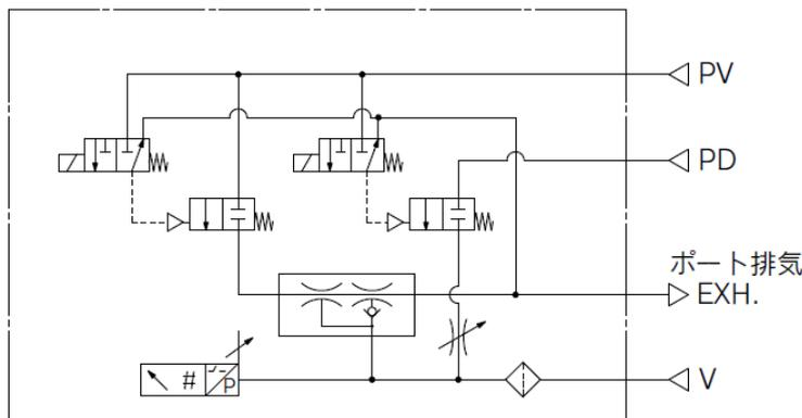
上記回路図は供給弁 : N.C. 破壊弁 : N.C.
