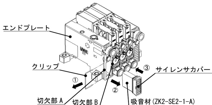
エジェクタシステムのマニホールド複合排気仕様は、エンドプレートに吸音材が内蔵されています。吸音材が目詰まりしますと、エジェクタの性能が低下し、吸着ミスや応答遅れの原因となります。吸音材の定期的な交換をおすすめします。
