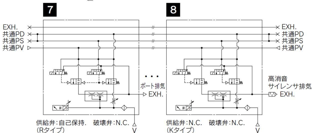
■オプション -D (個別破壊圧供給 (PD) ポート付)
