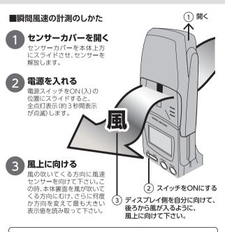
●瞬間風速が20m/sを超えたときには、20m/ s と表示し、点滅します。 ※風速は1秒毎に計測し表示します。
