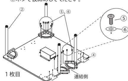
手順3. 2枚目の天板へ、2本の②脚を連結側の反対側の角にあるネジ位置に合わせ、⑥ワッシャーを入れた⑤ネジで仮締めしてください。
