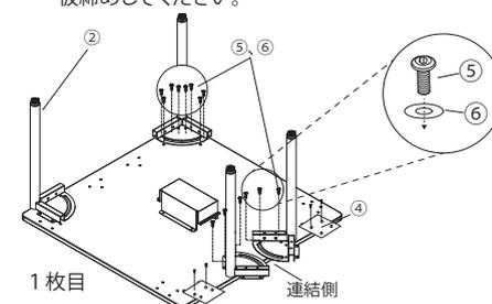
手順3. 2枚目と3枚目の天板を裏返し、それぞれ図のように②脚と④連結金具を、ネジ位置に合わせ、⑥ワッシャーを入れた⑤ネジで仮締めしてください。
