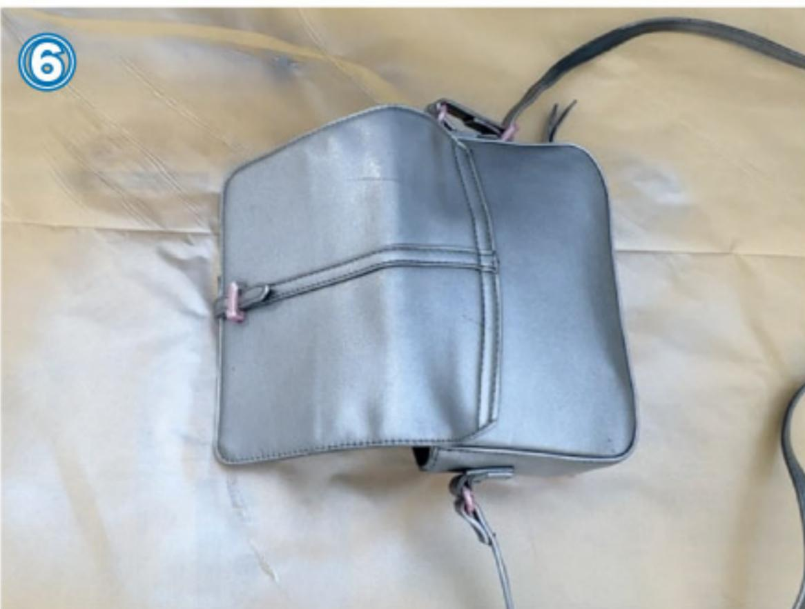
クリヤーの塗布が完了したら 5 分ほどおき養生を剥がします。剥がしたら動かさずに 15 分ほど置いて乾燥させます。
