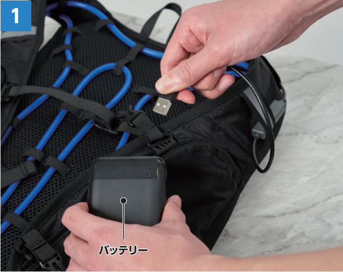
バッテリーを取り出し、ケーブル端子を抜いてください。
