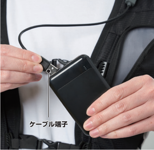
ケーブル端子をバッテリーのポートに差し込みます。
