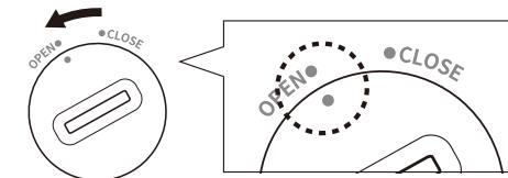
2. +と-の極性表示に合わせて、コイン形リチウム電池(CR2032)を2個セットし、電池蓋を矢印の方向に回して閉めます。
