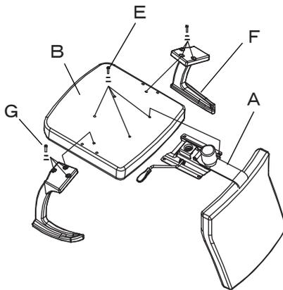
座クッション(B)を裏返し、背クッション・本体機構部(A)を本体取付用ボルト(E)でしっかりと固定します。次に固定肘(F)を肘取付用ボルト(G)でしっかりと固定します。
