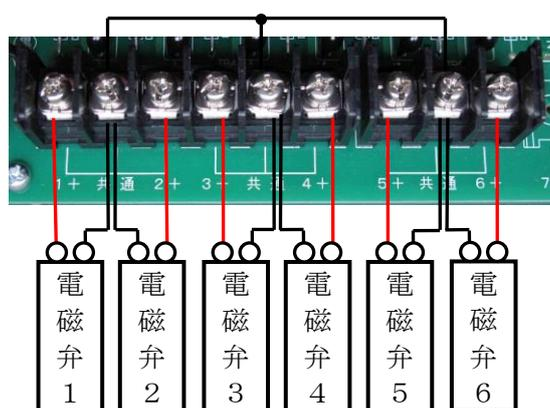
(7) 1系統電磁弁を1+と共通に接続します。
