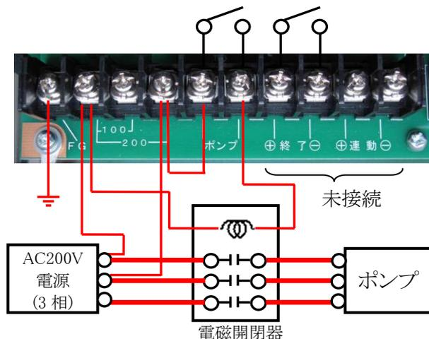
電源から電磁開閉器およびポンプへの配線は、ポンプの電流容量に適した太さのものを使用してください。
