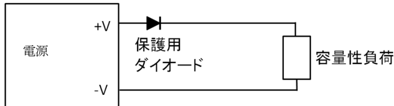
図7-6 容量性負荷への接続
