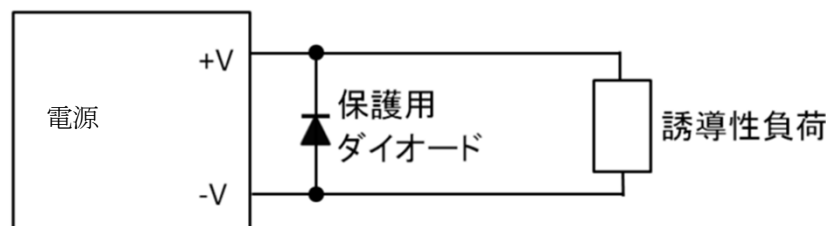
図7-5 誘導性負荷への接続
