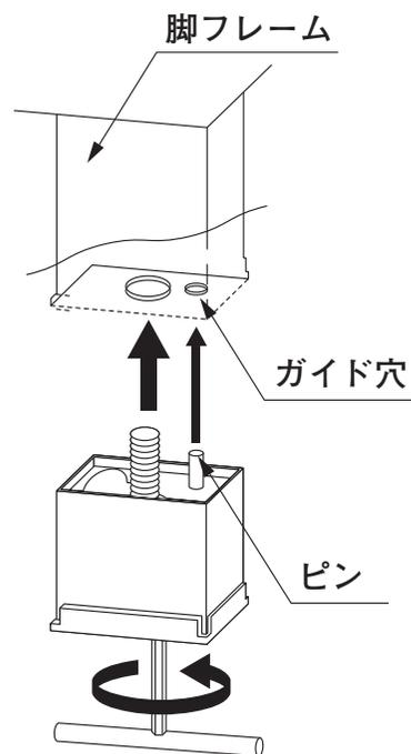
手順3 手順2で作ったものを作業台脚フレームにねじ込みます。
