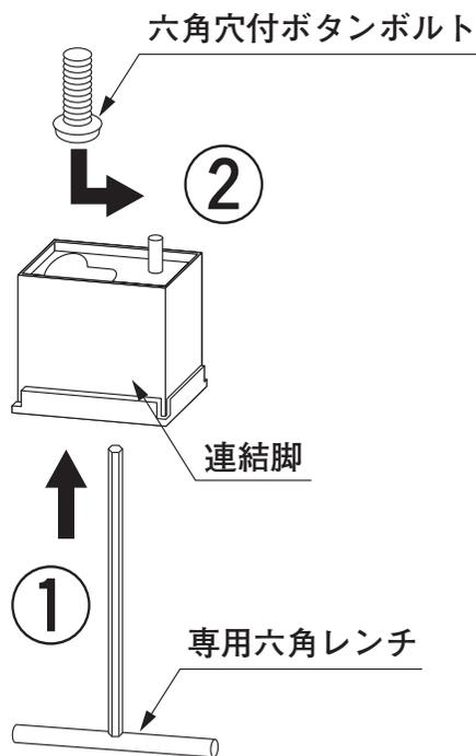
手順2 専用六角レンチ（別売）を連結脚の下から差し込み六角穴付ボタンボルトを取付けます。
