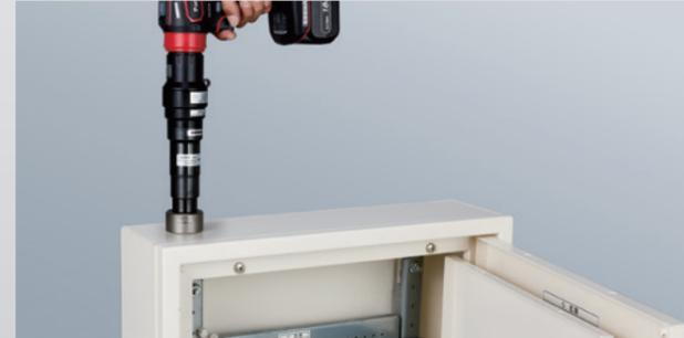
鋼板の打抜き
