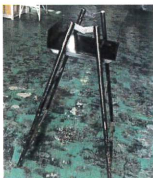
オイルタンク台
