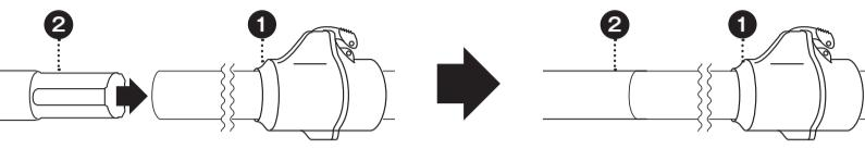
① ポールセットの先端に、② 連結ポールの溝がついた方を差し込み、突き当たるまで押し込みしっかりと連結させます。
