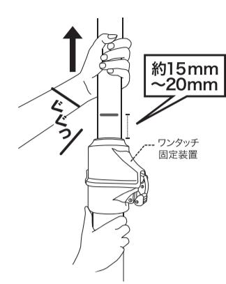
(1) 上部固定盤が軽く天井につく程度に押し上げ、えんぴつで下図のように線をつけます。
