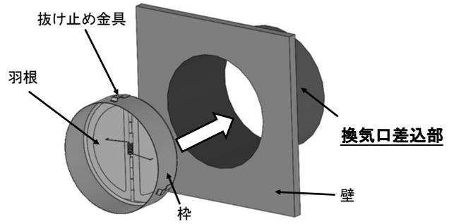
風の吹き出し方向に羽根が開くように取り付けてください。
