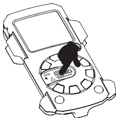
TEST MΩ ボタンを押す
