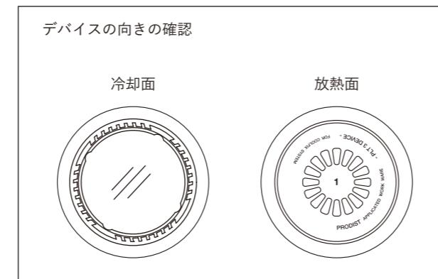
2 ベスト外側からみて、以下の図の配置でペルチェデバイスを取付けます。
