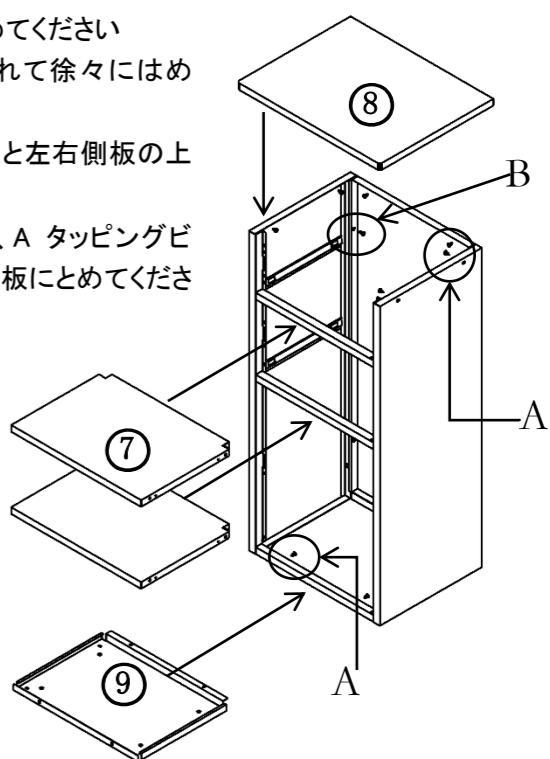
6. B ビス(短)\*1 本でJ 順倒防止金具と本体を止めてください(オプションで、南京錠とワイヤーで周りの柱などに固定してください)
