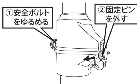
①安全ボルトの締め付けをゆるめ
