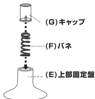
右図のように逆さにし机の上で『ガシャン』と音が鳴るまで押さえつけます。押さえ付けた後、キャップが壊れないことを確認してください。
