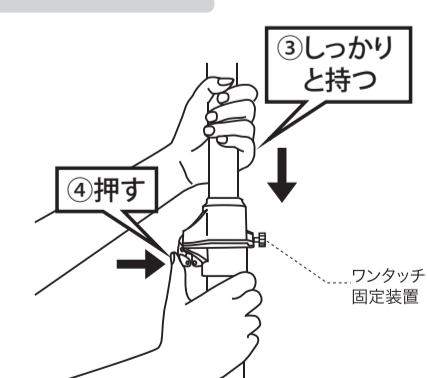
③上部パイプを持ちながら、④ワンタッチボタンを押してください。上部パイプを持たずにワンタッチボタンを押すと、上部パイプが急に落ちてきて大変危険です。
