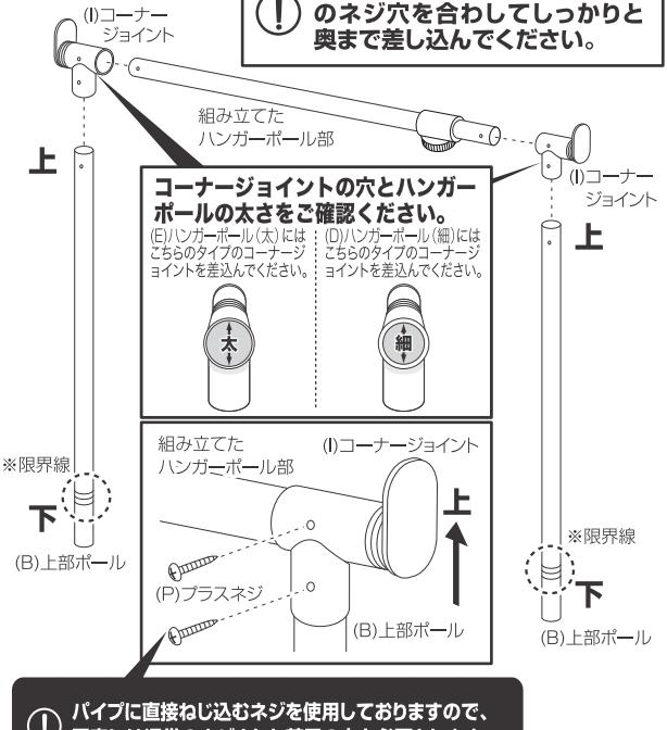
パイプに直接ねじ込むネジを使用しておりますので、固定には通常のネジよりも若干の力を必要とします。
