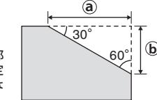
\*ワーク形状によってはユニット部が干渉して、30°面取寸法を測定しての60°面取寸法算出ができない場合があります。
