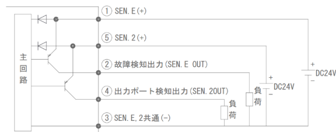
図 12. 圧力センサ電気回路図(マイナスコモン配線タイプ 1:N1)
