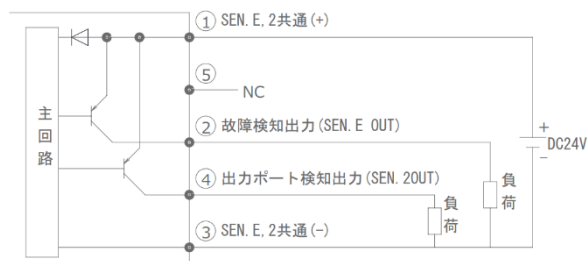
図 11. 圧力センサ電気回路図(ダブルコモン:D)
