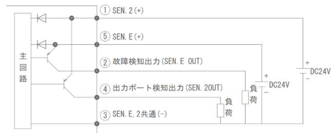
図 13. 圧力センサ電気回路図(マイナスコモン配線タイプ 2:N2)
