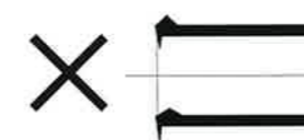
外バリ、内バリ ※継手ゴムリングへの傷や欠損
