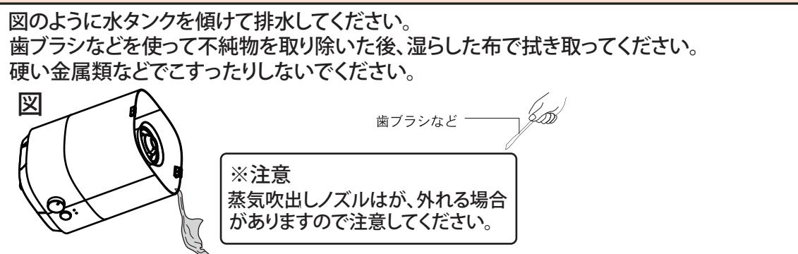
※水タンク内の蒸気吹出しノズル下の蒸発皿（水を沸騰させる部分）に水分中に含まれるカルキ等の不純物が使用に伴い堆積してきます。
