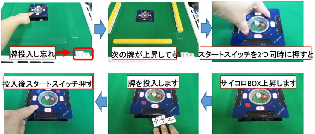
⚠ 天板を外して麻雀卓を動作させる場合、外光によって正常に牌を2段積セット出来なくなる場合がありますので、必ず遮光して下さい。
