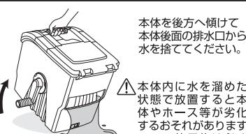
本体を後方へ傾けて本体後面の排水口から水を捨ててください。
