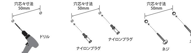
●コンクリート面に直径8mm、深さ40mmの下穴を開けます。
