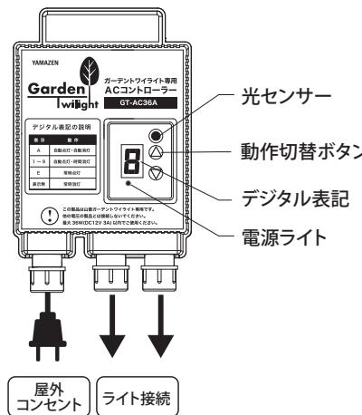
すべての接続部が緩んでいないことを確認してください。電源プラグを屋外用コンセントに差し込み動作確認します。最初に“A”が表示され「▲」「▼」(動作切替ボタン)を押すことで切り替わります。
