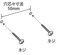
●壁面にネジを打ち込みます。
