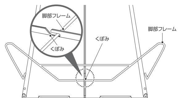
3 脚部フレームが確実にくぼみに入っていることを確認し、脚部フレーム先端部を引っ張り、固定穴に入れて固定してください。(2か所)
