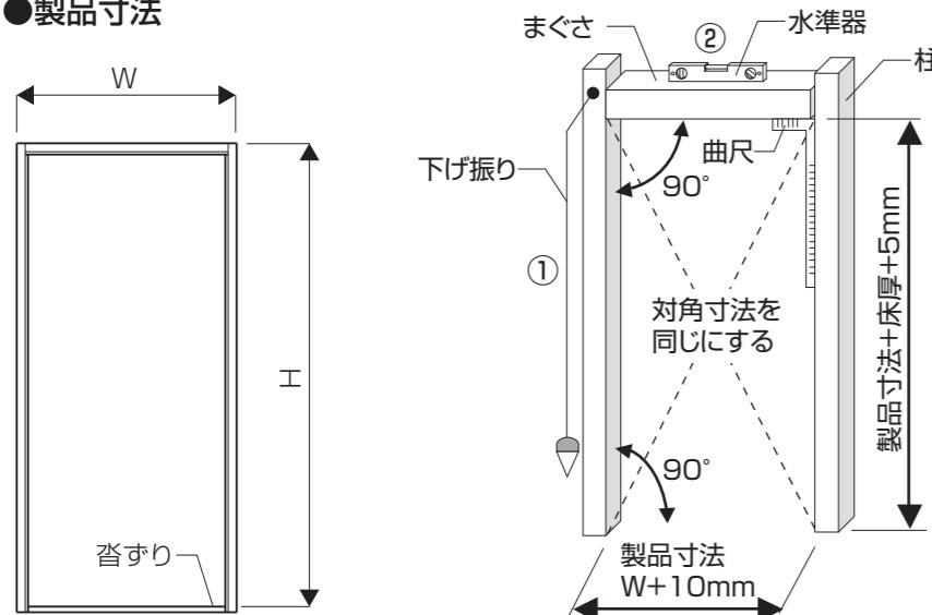
①下げ振りを使って、柱が垂直になるように取付けてください。
