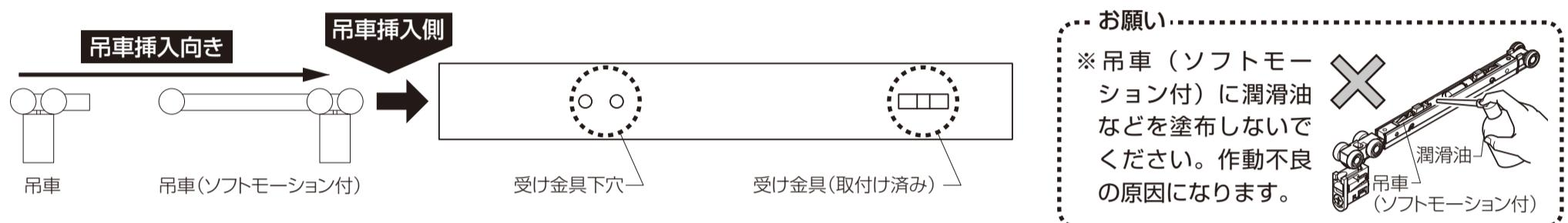
④上レールにソフトモーション受け金具を固定ねじ(低頭小ねじM3×12)と受け金具裏板を使用して固定します。
