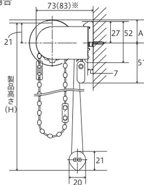
※正面付けの場合、製品高さ(H)はローラーパイプ上端からボトムレール下部までの寸法です。
