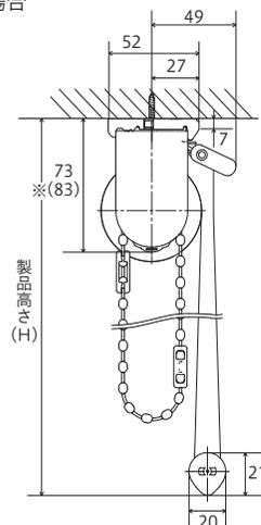
※天井付けの場合、製品高さ(H)はブラケット上端からボトムレール下部までの寸法です。
