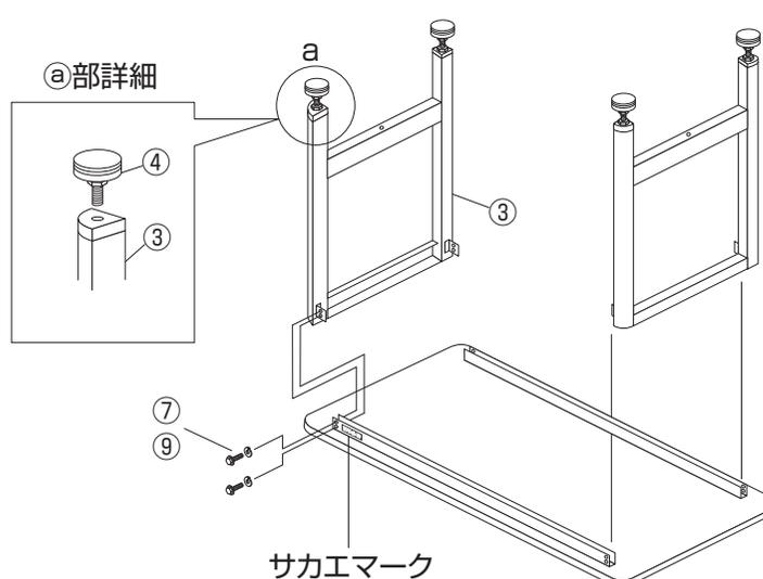
③本体を起こして、カンヌキ⑤もしくは中板⑥を六角穴付ボタンボルト⑧とバネ座金⑨、平座金⑩、六角ナット（フランジ付）⑪で仮止めして下さい。
