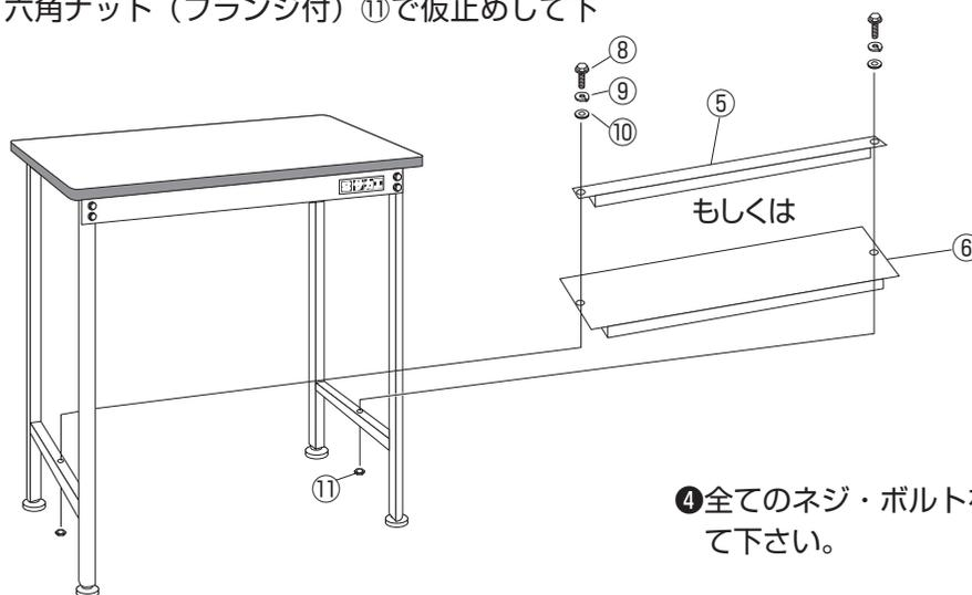
④全てのネジ・ボルトをはずれない様に本締めして下さい。
