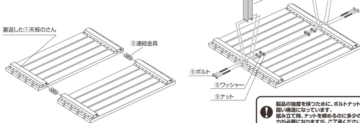
製品の強度を保つために、ボルトナットは固い構造になっています。組み立て時、ナットを締めるのに多少の力が必要になりますが、ご了承ください。
