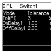
UP または DOWN ボタンを押して、項目を選択し、SET ボタンを押します。 ↓ 出力動作の設定に移ります。
