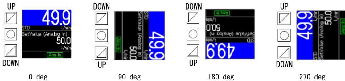
表示回転角度で UP および DOWN ボタンの割り当てが変更します。
