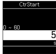
※：電源投入時後、測定モードに移行してから制御動作開始までの時間を設定します。
