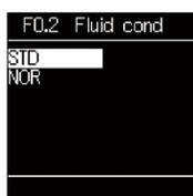
STD : 標準状態 (温度 20[°C]、絶対圧力 101.3[kPa]、湿度 65[%R. H.] の体積に換算した流量)
