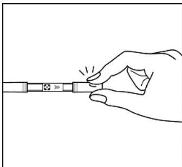
(2) PE キャップをはずし、カーボンビーズアクティブと吸引ポンプをお手持ちのシリコンチューブ等で接続します。
