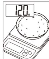
計量物を載せると計量物の重さだけが表示される
