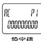
積算出力設定範囲は 9 桁の設定値と単位表示 ( $\times 10^3$  L) で表示されます。
