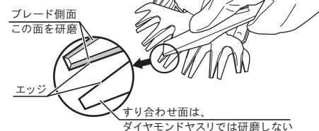
図1 (ブレード側面部の断面図)
